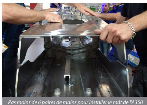
Pas moins de 6 paires de mains pour installer le mât de l'A350
